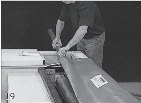
**Inserting the Leading Edge Tube**
